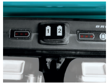
LED indicatori carica batterie
