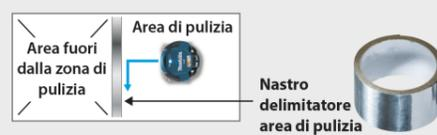
Permette all'utente di definire una superficie di pulizia delimitata utilizzando un nastro delimitatore dei confini che il Robot Pulitore non potrà oltrepassare.
