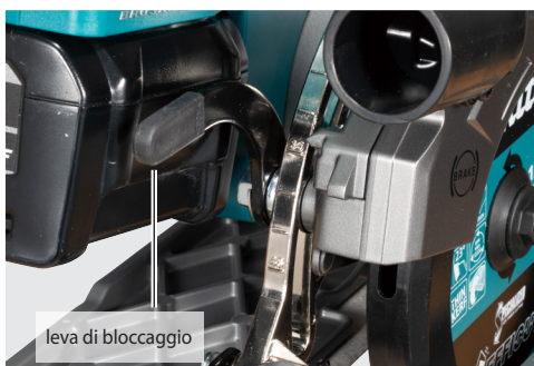
Regolazione rapida della profondità di taglio
