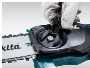
Regolazione della tensione della catena allentando e riavvitando la leva.
