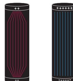
La batteria BL4040F è caratterizzata da una resistenza interna particolarmente bassa grazie all'impiego di celle agli ioni di litio con una composizione chimica unica e un design "tabless".
